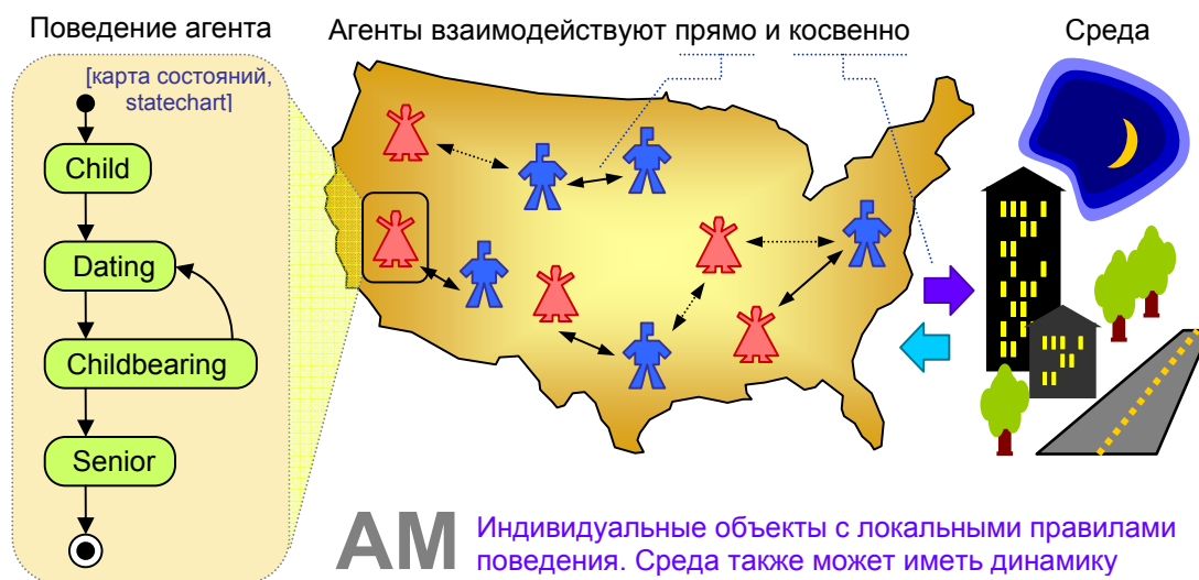
Рис 7: Типичная архитектура агентной модели. Поведение (карта состояний) в AnyLogic™
