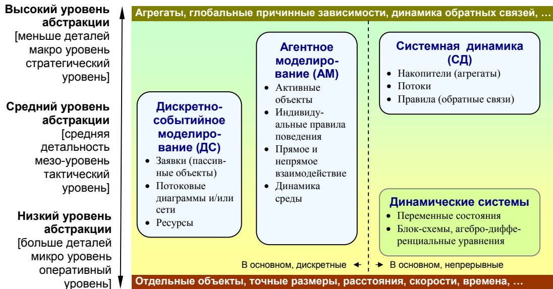
Рис 3: Подходы в имитационном моделировании на шкале уровня абстракции
